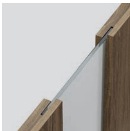
spojení se sklem „na hranu“ křídlo polodrážkové
