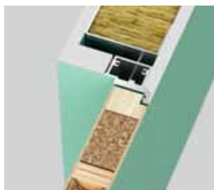
Opačný falc (otváranie do vnútra) - ľavé dvere
