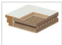
réteges szerkezetű betét (42 dB)
