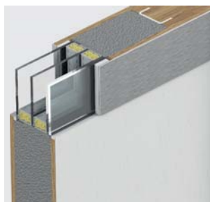
Dwukomorowe przeszklenie antywlamaniowe klasy P4 i ramka ze stali nierdzewnej
