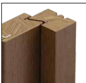
Einbruchhemmender Türfalz an der Bandseite
