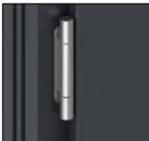
Scharnier Premium Simonswerk seri 4000 • Regulierung 3D • Tragfähigkeit 160 kg. • Anti-Einbruch verstärkt • 30 Jahre Garantie für Arbeit (200 Tsd. Zyklen)
